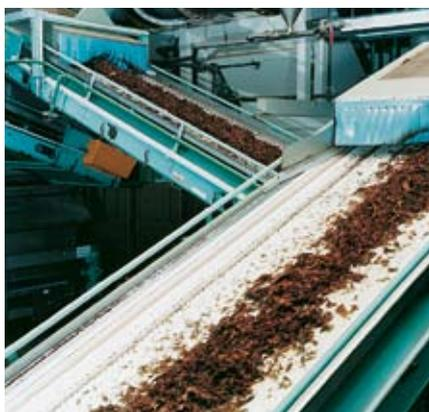
Наклонный конвейер в табачной промышленности. В этой отрасли угол наклона может достигать 22° при использовании конвейерных лент с гладкой поверхностью.
