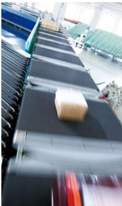
Поперечный сортировщик в распределительном центре. Сильное ускорение требует от поверхности конвейерной ленты максимально высокого коэффициента трения.
