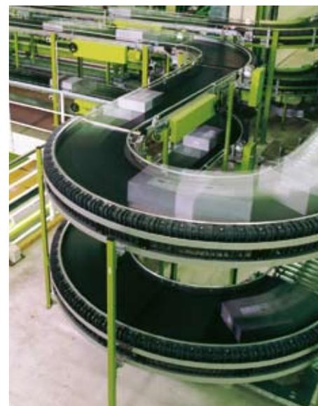
Криволинейный конвейер в распределительном центре
