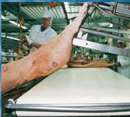
Siegling Transilon используется для транспортировки упакованных и неупакованных пищевых продуктов. Частое мытье горячей водой и работа при низких температурах – обычные условия эксплуатации в этой отрасли.
