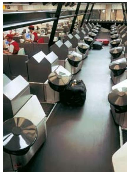
Приемный конвейер в зоне регистрации аэропорта. Плоская поверхность ленты обеспечивает плавную боковую загрузку багажа даже на широкую конвейерную ленту. Огнестойкость материалов – обязательное требование в современных аэропортах.
