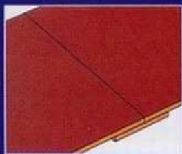
соединение встык с нижней подкладкой
