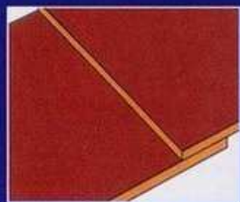
соединение внахлест, угол от 45^{\circ} до 90^{\circ}
